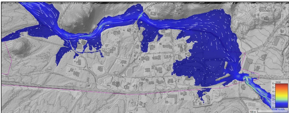
Figur 15: Illustrasjon av modellert strømnings situasjon ved en 200-årsflom inkludert klimapåslag.
